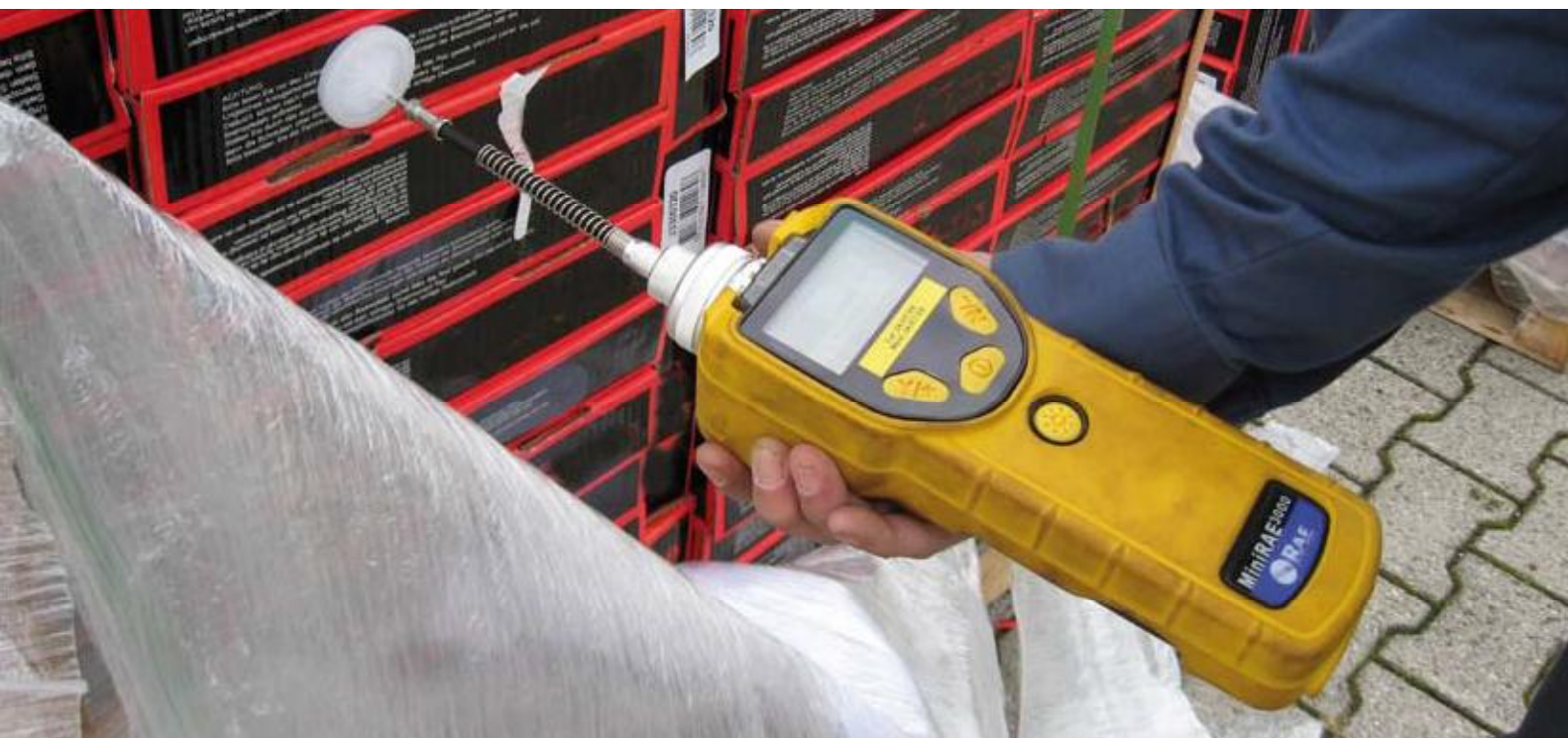
Meting bij onderzoek naar productgassen in de verpakking.
